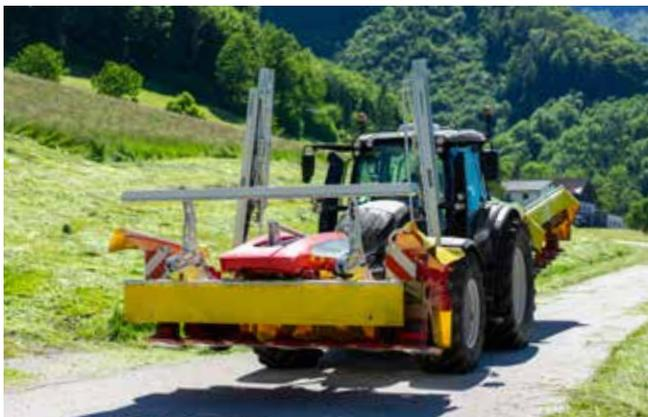
Lorsque le SENSOSAFE 1000 est utilisé avec l'option SENSOSAFE sur l'ALPHA MOTION, aucun distributeur complémentaire n'est nécessaire pour le repliage. Une présélection sur le terminal SELECT CONTROL commande le repliage.
