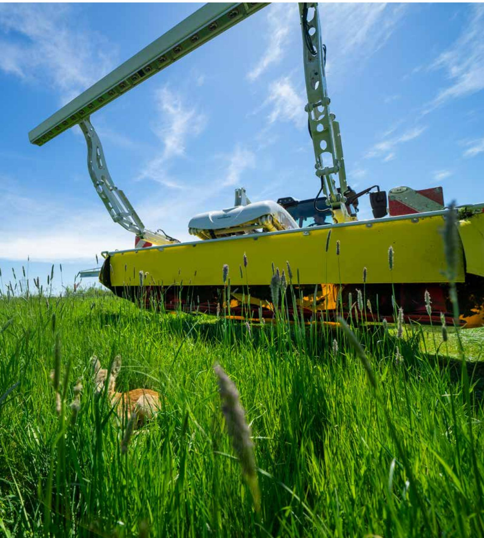
Fauchez vos prairies sereinement et récoltez un fourrage de qualité supérieure grâce à la technologie innovante de PÖTTINGER. SENSOSAFE est un système d'assistance automatisé reposant sur des capteurs pour la détection de la faune, qui vous aide à détecter les animaux sauvages dans vos prairies. La faune est protégée et votre fourrage reste propre. Et tout cela avec une grande efficacité et un confort inégalé.
