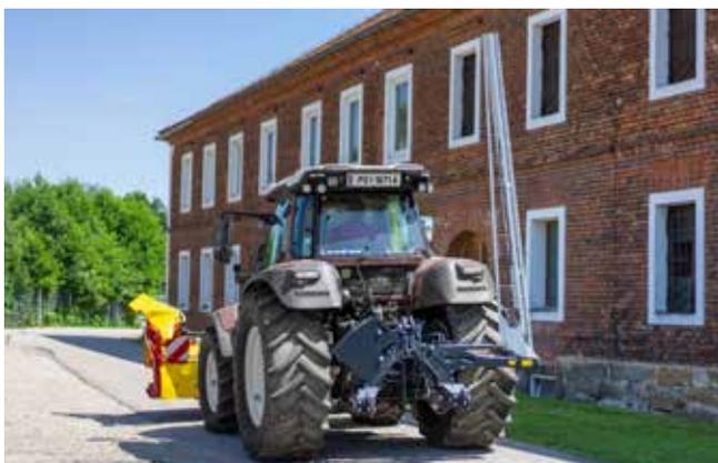
Pour l'utilisation du SENSOSAFE 300 à l'arrière ou à l'avant sans faucheuse frontale, un lestage est disponible en option. En effet, si l'attelage du tracteur présente un certain jeu, cela peut éviter les vibrations sur la poutre.
